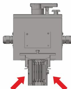
**4** Kutusunun busbar gövdesine kelepçe sistemi yardımıyla vidalanarak montaji sağlarıń.
