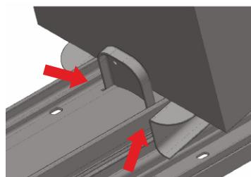
**3** Çıkış kutusunun busbar gövdesine kanca sistemi yardımıyla takılmasını kontrol ediniz.
